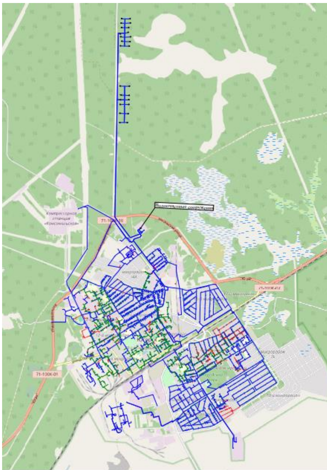
Рисунок 14. Сети водоснабжения города Югорск, существующее положение
